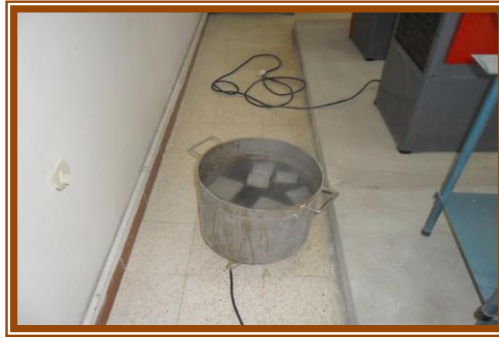
Figure (III-8) : cuisson des éprouvettes dans l'eau.
