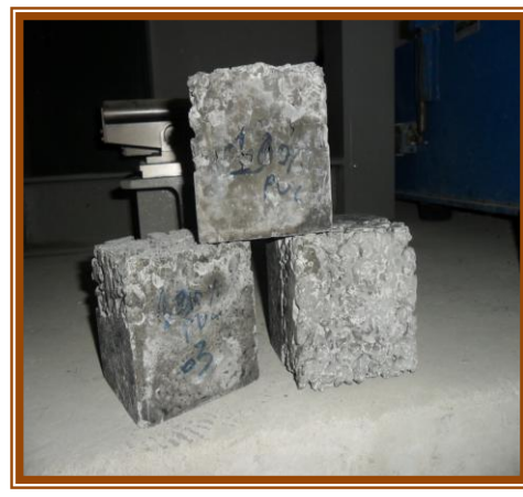
Figure (IV-40) : épreuve de béton de 100% de granulats de PVC après traitement.
