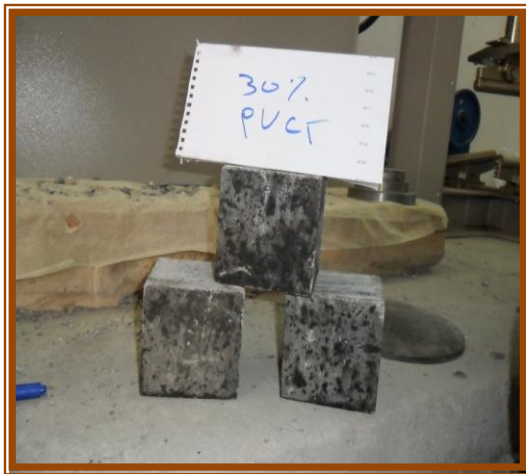
Figure (IV-37) : épreuve de béton de 30% de granulats de PVC après traitement.
