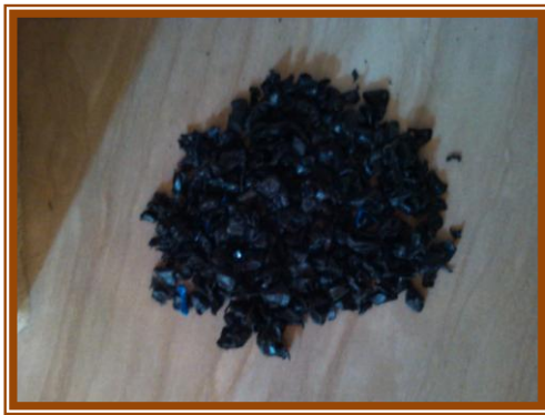
Figure (IV-5) : Les granules de PEHD avant traitement.
