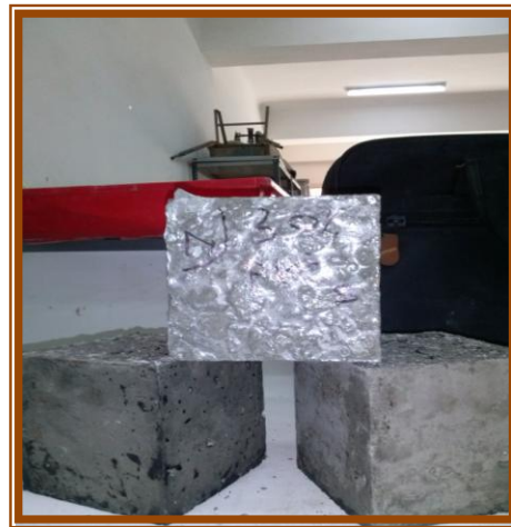
Figure (IV-38) : épreuve de béton de 30% de granulats de PVC avant traitement.
