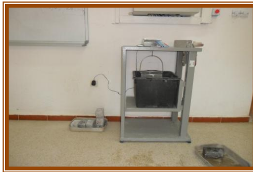
Figure (III-9) : balance de la mesure du masse volumique par déplacement d'eau.
