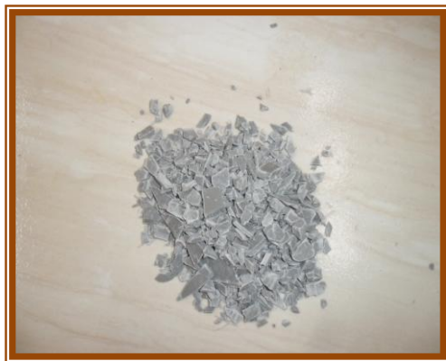
Figure (IV-7) : Les granules de PVC avant traitement.
