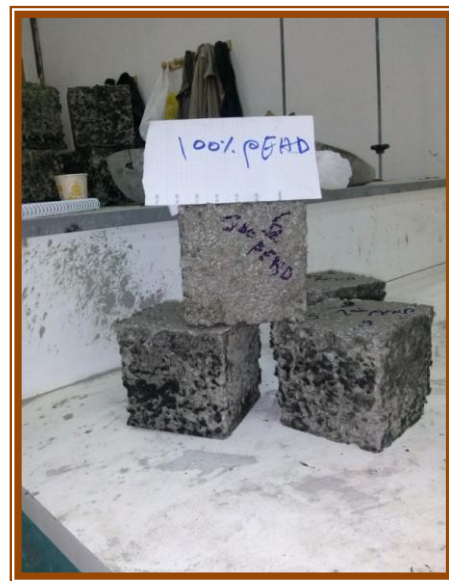
Figure (IV-44): épreuve de béton de 100% de granulats de PEHD après traitement.
