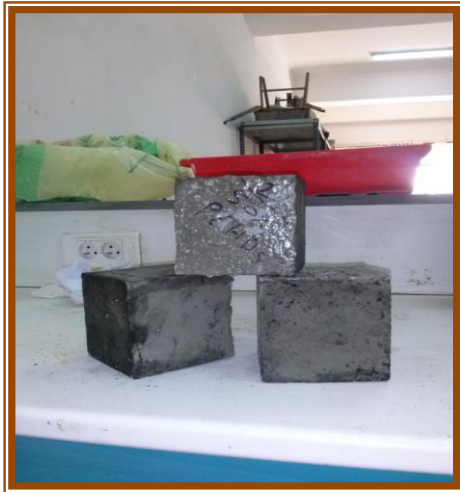
Figure (IV-41): épreuve de béton de 50% de granulats de PEHD avant traitement.
