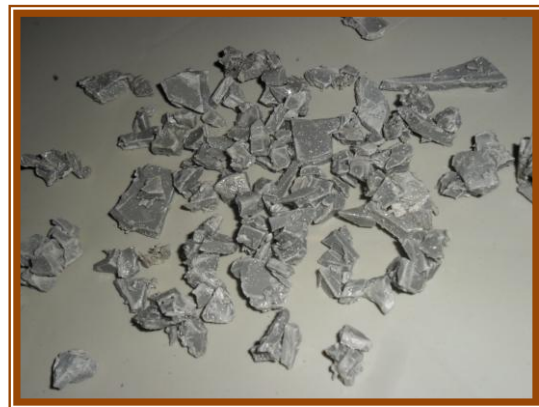
Figure (IV-8) : Les granules de PVC après traitement.
