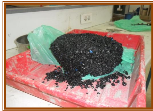
Figure (IV-6) : Les granules de PEHD après traitement.
