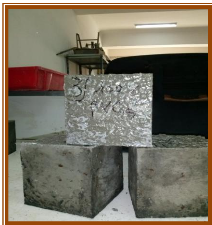
Figure (IV-39) : épreuve de béton de 100% de granulats de PVC avant traitement.
