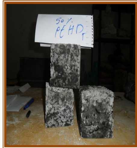
Figure (IV-42): épreuve de béton de 50% de granulats de PEHD après traitement.
