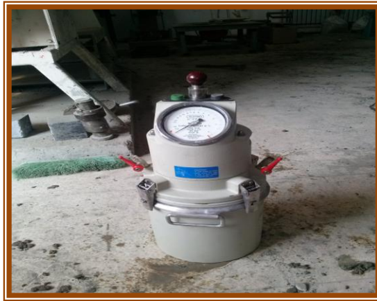
Figure (III-4): Aéromètre à béton.
