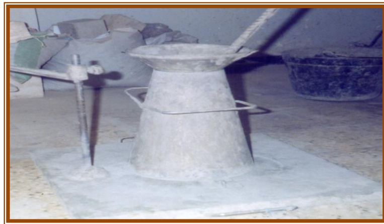
Figure (III-3): Cône d'ABRAMS.
