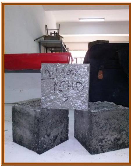
Figure (IV-43): épreuve de béton de 100% de granulats de PEHD avant traitement.
